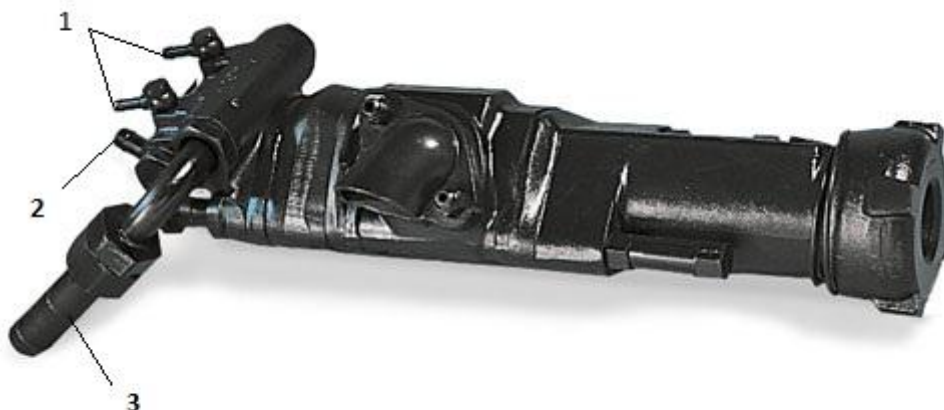
Рис. 1 Перфоратор ВВС 120 с присоединительными штуцерами для подвода воздуха к ударному механизму (3), к реверсивному вращателю (1) и для промывки/продувки (2).
